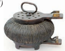
A Ganz-gyárban kifejlesztett transzformátor segítségével a villamos energiát nagy távolságra lehetett szállítani
