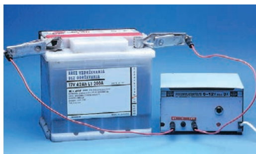
42.1. Ólomakkumulátor töltés közben. Mi keletkezik feltöltéskor az ólom-szulfátból az egyes elektródokon?
