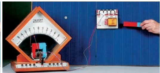
159.1. Ha egy tekercshez mágnest közelítünk (balra) vagy távolítunk, a tekercsben feszültség indukálódik
