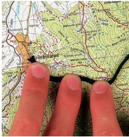
7. ábra. Hogyan tudod megmérni a térképen egy kanyargós útvonal hosszát? Például azt szeretnéd megtudni, hogy mennyit kell gyalogolnod, ha a vasútállomásra szeretnél kijutni. Vegyél egyik kezvedbe egy fonaldarabot, és egyik végét illeszd lakóházatok térképjeléhez! Majd másik kezveddel pontosan vezesd végig a fonalat annak az útvonalnak a rajzán, amelyen menni fogsz a vasútállomásra! A vasútállomás jelenél is fogd meg a fonalat! Illeszd két kézzel a vonalas mértékhez! Így már leolvashatod, hogy mekkora utat kell megtenned a valóságban.
